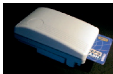
圖 6.6 採用短距離微波通訊系統及配備智能卡的車內儀器
